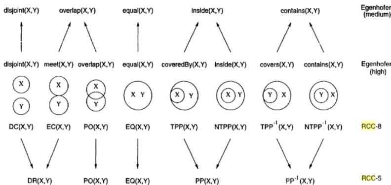
Abbildung 1: Zwei-dimensionale Beispiele für die Basisrelationen der RCC-Theorie und Egenhofers 9-Intersection-Modell und ihre Beziehung zu den beiden Kalkülen mit nur fünf Relationen (RCC-5, medium resolution).
